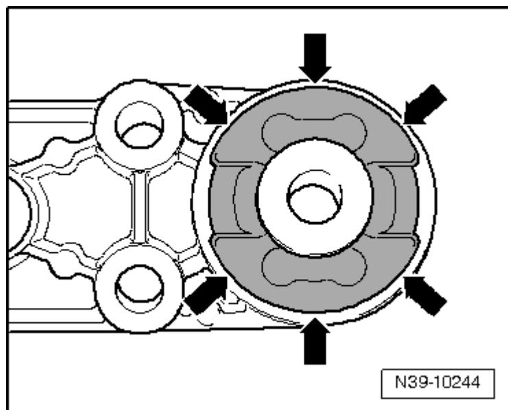
横梁 -2- 只能安装在后桥主减速器 -3- 一个位置上。同时，椭圆形的孔-箭头-必须位于右下侧。
